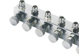
A9-6 Rozgałęźnik 6-końcówki 1x G1/4 Female- 6x 1/8 male Przepływ powietrza regulowany
