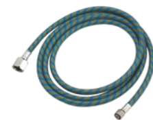
AH-21 Przekrój: 7.5x4.5mm Długość: 1.8m, 3m Złącze: G1/4"-G1/8"
